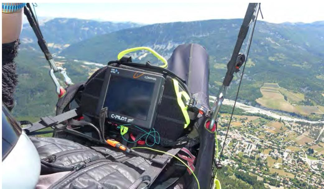
Le poste de pilotage est très compact, près du regard. Sous les mains, à droite une bonne poche zippée. Idem de l'autre côté, avec de plus, vers l'arrière, un rangement prévu pour le drag chute. Dans les détails, poche radio sur l'épaule, compartiment ballast, passages prévus pour le tuyau de gourde, le tuyau de vidange « penilux », et le tuyau ballast.
