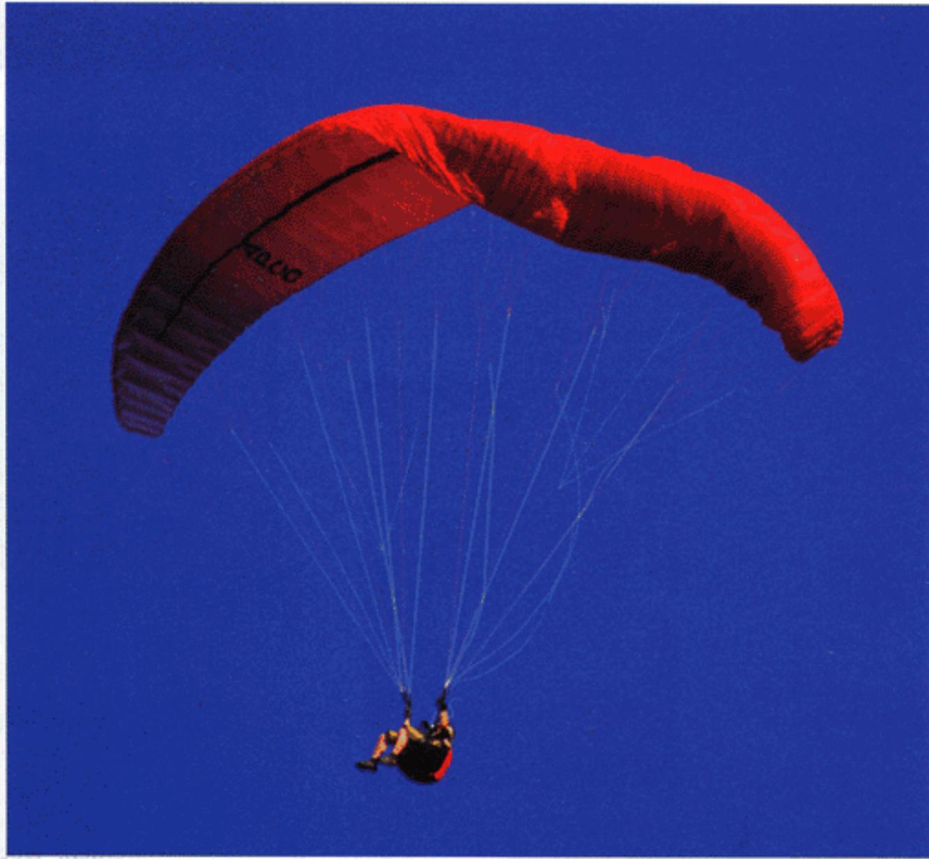
Einklapper sind mit dem Simba beherrschbar: Der Flügel dreht nur etwa 90° ab und öffnet selbständig
