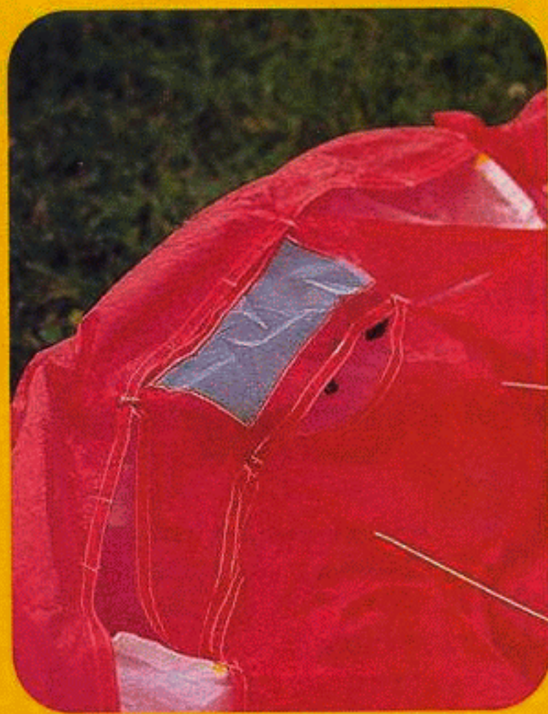
particolare del bordo d'attacco del nuovo Presta: la retina protegge un particolare sistema "a tapparella" che chiude la bocca durante il volo ma la lascia aperta in fase di gonfiaggio
