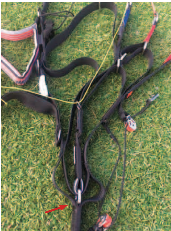
« SRS » : bascule du centre de poussée du profil avec l'action de l'accélérateur.
