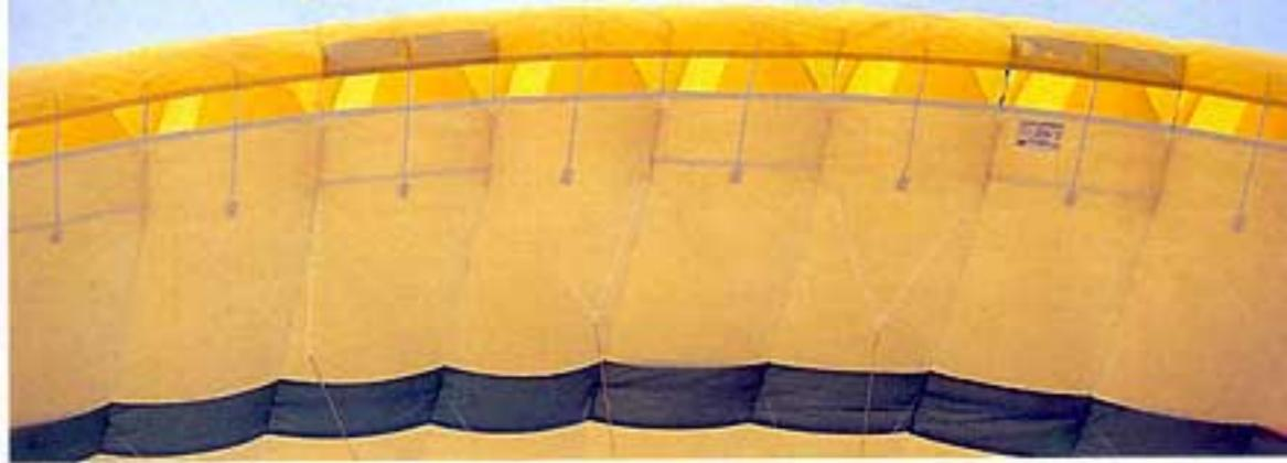
En la foto se aprecian las largas varillas plásticas (sistema Flexon) que envuelve todo el borde de ataque y las válvulas (Hit), que aseguran la suficiente alimentación al ala cuando baja la incidencia o se vuela acelerando.
