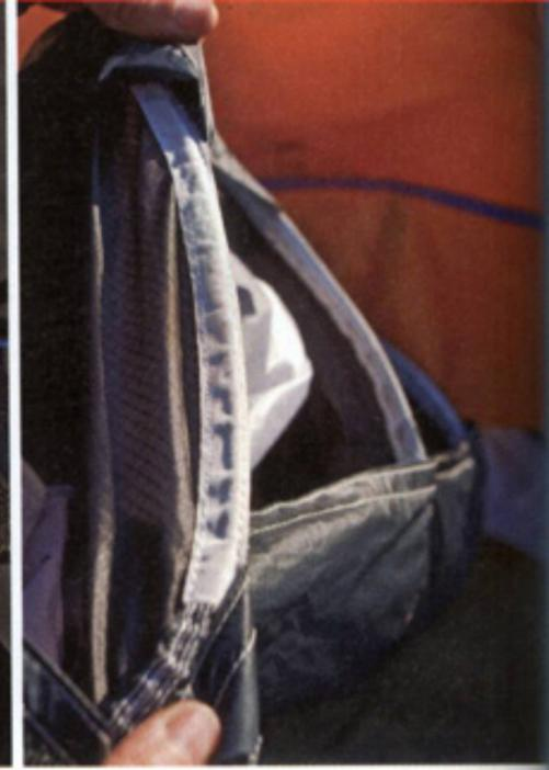
Die Tragegurte sind bei Reflexschirmen oft recht komplex. Das zusätzliche Trimmersystem und die zweite Steuerleine, die an den Stabilobereich angelenkt wird, machen alles etwas unübersichtlicher. Apco mildert den Effekt durch eine ganz deutliche Kennzeichnung der Leinenebenen und eine gut sicht- und spürbare Rasterung im Trimmer.
