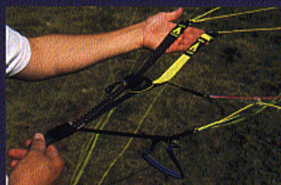
Gewöhnungsbedürftig: Beim Fiesta hängt die äußerste A-Leine auf einem Extra-Gurt mit dem B-Gurt zusammen
