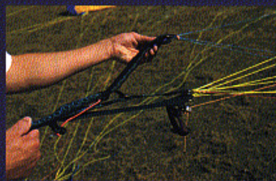
3-Ebenen Tragegurt mit Ohrenanlegehilfe beim Alpha 2
