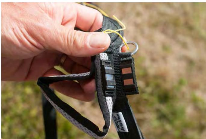
Poulies métalliques, trims costauds et clairement marqués, un élévateur relativement facile, et des aimants bien pensés aux commandes. Si on clipse les freins "de travers", ils se tournent automatiquement dans le bon sens, c'est bluffant!
