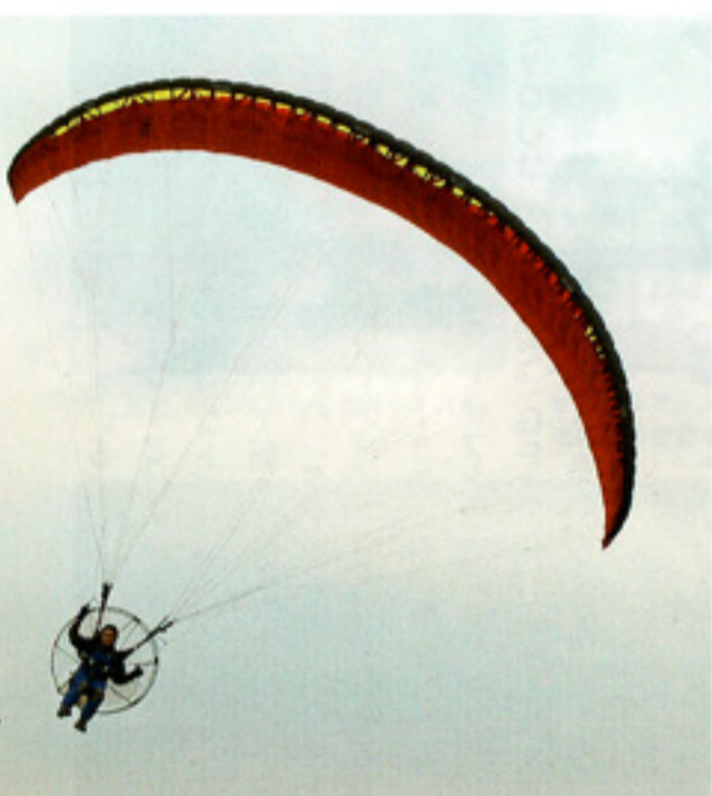
大きめのアーチが印象的。インテークはFLEXORパテンにより整形がとてきれい。
